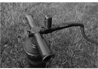
Zusammen mit der Pumpe wird ein Überdruckventil geliefert, das dafür sorgt, dass nur eine bestimmte Luftmenge eingefüllt wird. Versichern Sie sich, dass das Überdruckventil an der Pumpe angeschlossen ist. Die Luftschläuche werden mit maximal 0,5 bar (7psi) gefüllt. Benutzen Sie nur die mitgelieferte Luftpumpe und keine elektrischen Aggregate ohne Überdruckventil. Es besteht sonst die Gefahr, das der Schlauch platzt!
